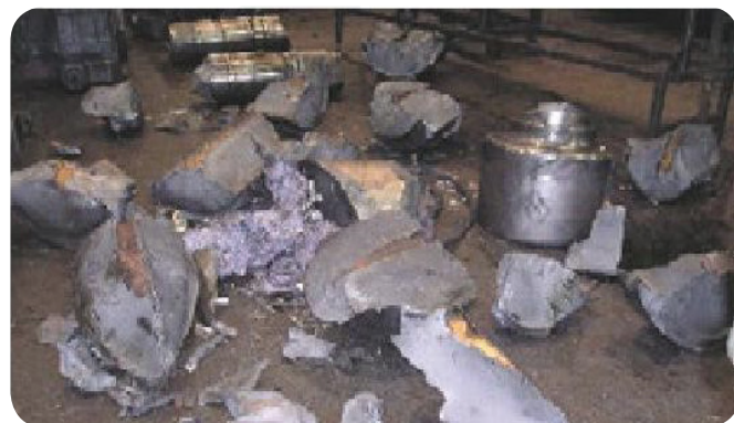
Exemple de résultats catastrophiques de fissures dans des rouleaux.
