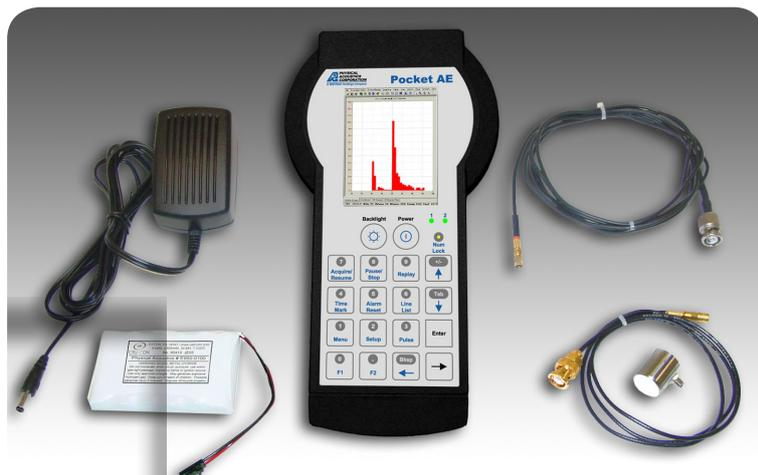
Le système portatif Pocket AE-2, unité bivoies EA, capteur EA type R15a, 1 mètre de câble capteur, 2 mètres de câble paramétrique avec connecteur et batterie d'alimentation.
